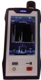
Fig. 6. The Raman Spectrometer (BRAVO – Bruker)
