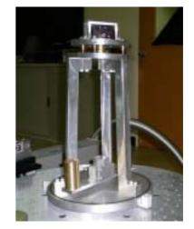
Fig. 1. Torsion strip pendulum
